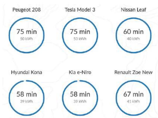
Temps de recharge sur une borne 24 kW DC pour les principaux modèles vendus en France
